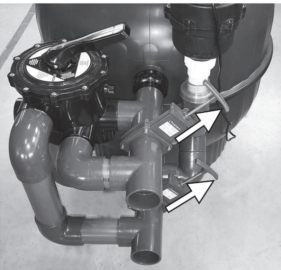
4. Stoppen Sie die Pumpe und stellen Sie das 6-Wege-Ventil in die **FILTER**-Position. Drehen Sie die Schieber wieder in die vollständig geöffnete Position (siehe Foto).
