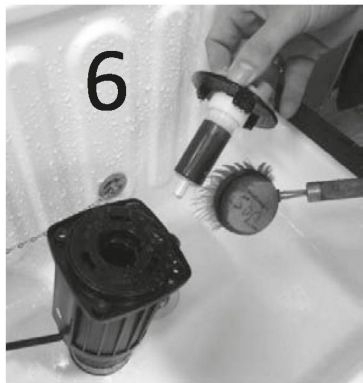
Rotor met water en borstel schoonmaken
