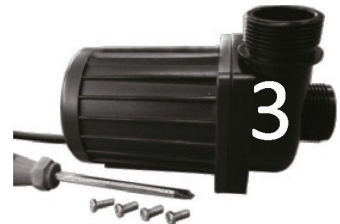
Schroeven van pomphuis verwijderen
