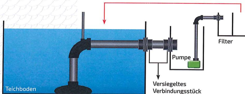
Aus dem Teich mittels z.B. Flansch 110 mm heraus in eine Pumpenkammer, in welcher die Pumpe steht. Von dort zum Filter und via Schwerkraft zurück zum Teich.
