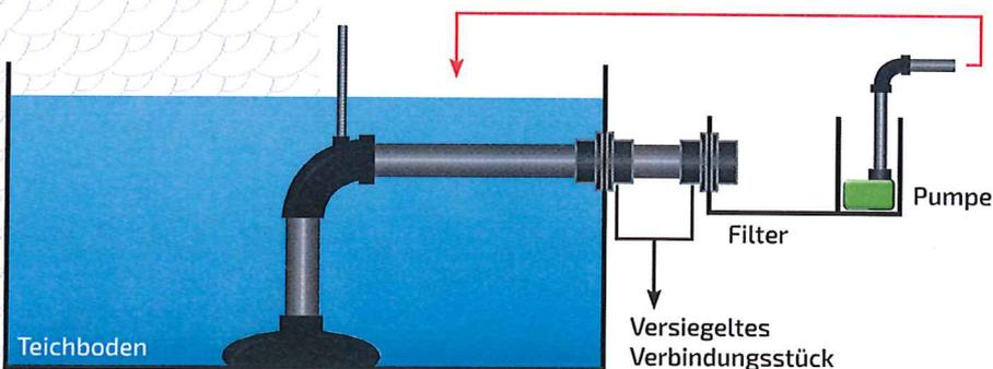
Aus dem Teich mittels z.B. Flansch 110 mm heraus direkt in den Filter. Von dort z.B. aus der letzten Kammer mittels Pumpe zurück zum Teich.
